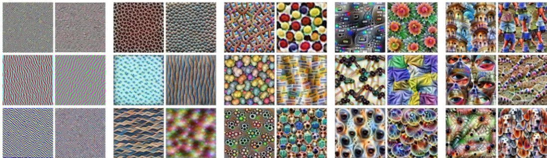
Figuur 8 Feature visualisation binnen de lagen van een convolutioneel neurale netwerk. Links: de 'eerste' lagen van het netwerk. Rechts: de 'laatste' lagen van het netwerk [13]
